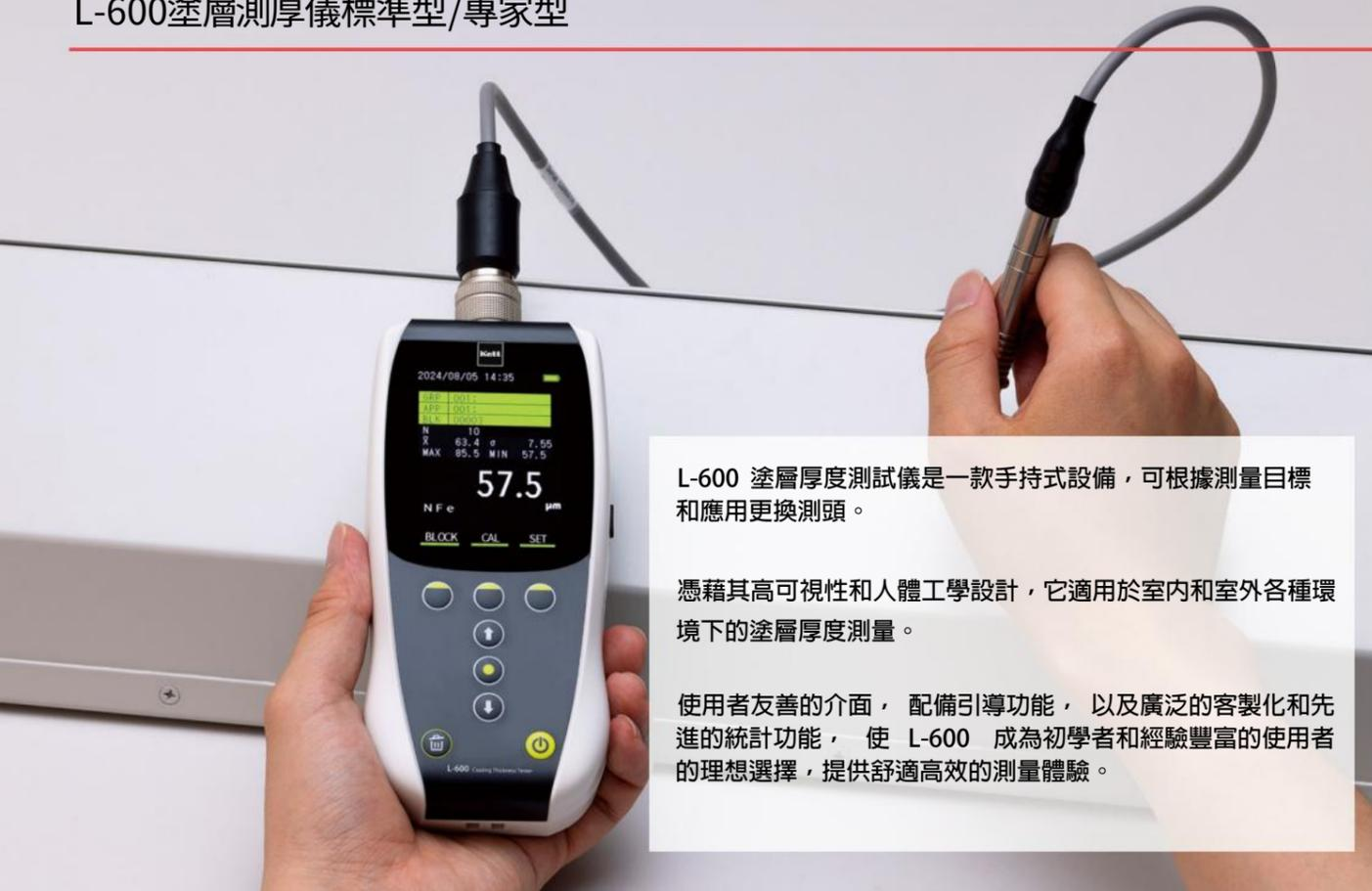
L-600 塗層厚度測試儀是一款手持式設備，可根據測量目標和應用更換測頭。
